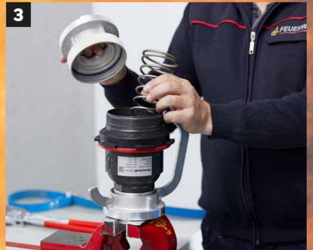
**3** Spannungsfreie Feder entfernen
