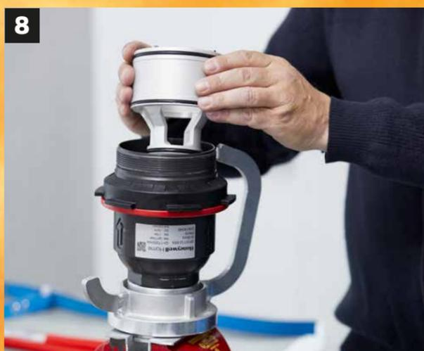
**8** Kolben und Feder wieder einsetzen
