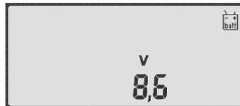
Mit dieser Funktion lässt sich jederzeit die Spannung der 9-Volt-Batterie anzeigen. Spannungen unter 5,5 Volt lösen Batteriewarnung aus: Im LCD rechts oben blinkt das Batteriesymbol, und es ertönt ein Dauerwarnton. Der Warnton kann durch Druck auf die Lautsprechertaste gelöscht werden, danach wird das Batteriesymbol statisch angezeigt. Diese automatische Batteriewarnung erfolgt in jedem Anzeigezustand des Gerätes, nicht nur bei der Batteriespannungsanzeige.
