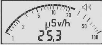
Die momentane Dosisleistung wird gleichzeitig analog und digital angezeigt. Die logarithmische bogenförmige analoge Balkenanzeige überstreicht zwei Dekaden. Benachbarte Bereiche überlappen sich jeweils um eine Dekade. Die Bereichsumschaltung erfolgt automatisch. Hierbei ertönt kurzfristig ein akustisches Signal, um auf die Änderung aufmerksam zu machen.
