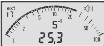
Beim Anschluss einer externen Sonde wird deren Typ oben links als »ext xy« angezeigt. Bereiche und Einheit werden automatisch
