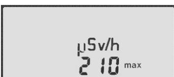
Das Symbol »max« zeigt an, dass es sich um den Höchstwert der Dosisleistung handelt, der nach einer Tätigkeit wie dem Ausmessen eines Strahlungsfeldes hilfreich sein kann.
