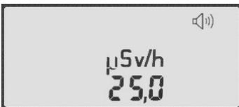
Das Lautsprechersymbol oben rechts zeigt an, dass es sich um eine Warnschwelle handelt, nicht um einen Messwert. Mit der Lautsprechertaste kann eine andere Dosisleistungswarnschwelle eingestellt werden. Es wird ein fester Satz von Warnschwellen angeboten, beim 6150AD5/E und AD6/E auch die programmierbare Warnschwelle.
