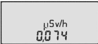
Der Mittelwert ist insbesondere bei kleinen Dosisleistungen von Vorteil, wenn die direkte Dosisleistungsanzeige relativ starken Schwankungen unterworfen ist. Man kann hiermit, allerdings unter entsprechend erhöhtem Zeitaufwand, eine wesentlich höhere statistische Genauigkeit erreichen. Die Ziffern der Digitalanzeige blinken, solange der statistische Fehler (eine relative Standardabweichung) größer als 5% ist. Beim 6150AD5/E und AD6/E lässt sich die Standardabweichung auch anzeigen.
