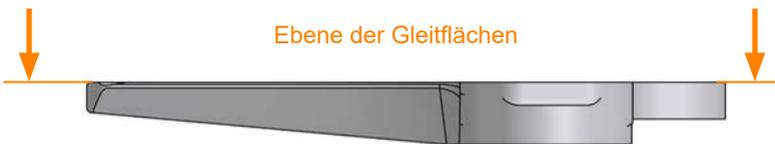
Sie müssen des Weiteren beim Abschleifen darauf achten, dass die Neigung der Schneidfläche in Richtung der Messerarmbewegung nicht geändert wird. Kontrollieren Sie die Neigung und Ebenheit der nachgeschliffenen Fläche evtl. mit einem geeigneten Messmittel.
