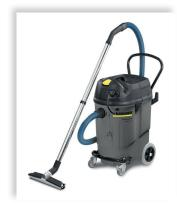
Nass- und Trockensauger zum kontinuierlichen Absaugen und Entsorgen von Schmutzwasser. 55 Liter Kunststoffbehälter, zwei Bockräder, zwei Stopp-/Lenkrollen, Schubbügel. Entnehmbare Entsorgungspumpe, mechanisches Doppelschwimmersystem für rechtzeitiges Unterbrechen bei Erreichen des Maximalfüllstandes, Grobschmutzfilter, Pumpenabgang Kupplung Storz C mit Absperrhahn
