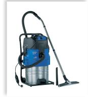
Nass- und Trockensauger zum kontinuierlichen Absaugen und Entsorgen von Schmutzwasser. 70 Liter Edelstahlbehälter, automatische Entleerung. Zwei Transporträder, Schubbügel, Grobschmutzfilter. Integrierte Tauchpumpe, Filtereinsatz aus Edelstahl, Pumpenabgang Kupplung Storz C
