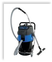
Hochwasser- und Schlammsauger zum kontinuierlichen Absaugen und Entsorgen von mit Schlamm, Steinen und sonstigen Fest- und Schwebstoffen grob verunreinigtem Wasser. 80 Liter PE-HD-Behälter, LED-Füllstandsanzeige, elektronische Niveauerfassung mit automatischer Entleerung. Zwei Bockräder, zwei Stopp-/Lenkrollen, Schubbügel. Motorgehäuse aus Edelstahl. Zweikanalrad-Schmutzwasserpumpe für verstopfungsfreien Permanentbetrieb, Korndurchgang 50 mm, Pumpenabgang Kupplung Storz C
