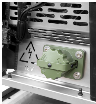
NATO-Fremdstartsteckdose 12 V DC und OBD II Diagnosestecker
