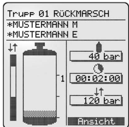
6. Ändern Sie – wenn nötig – mit den Navigationstasten (⬆️/⬇️) den aktuellen Flaschendruck der Atemschutzflaschen.
