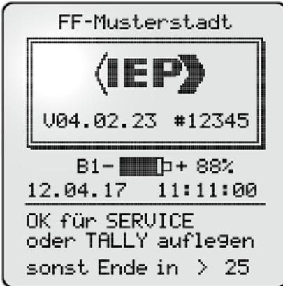
Die Anzeige zeigt die Batteriekapazität des aktuell verwendeten Batteriefaches. Verwenden Sie das Testprogramm, um sich die Batteriekapazität beider Batteriefächer anzuzeigen (siehe auch Kapitel [8.2 TESTPROGRAMM DURCHFÜHREN](#)).
