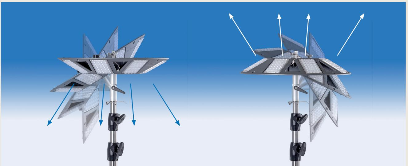
Der Stativ-Adapter kann von beiden Seiten in die Aufnahme eingeführt werden, so ist es möglich nach unten oder nach oben zu leuchten. Mit dem Kippgelenk lässt sich die N8LED in unterschiedliche Positionen von 0° bis 90° ausrichten.
