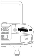
Mit dem rechten Rädchen wird das Schwenken des Gimbals eingestellt. Wenn Sie das Rädchen nach rechts drehen, schwenkt der Gimbal im Uhrzeigersinn. Wenn Sie das Rädchen nach links drehen, schwenkt der Gimbal entgegen des Uhrzeigersinns. Der Gimbal (bzw. die Kamera) verbleibt in der Ausrichtung, wenn Sie das Rädchen loslassen.
