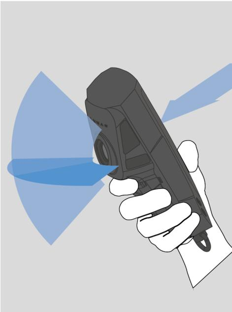
Die Richtungssuchantenne des LUNAR-Geräts ist an der Achse der [Wärmebildkamera](#) ausgerichtet.
