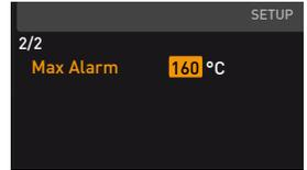
8. Einstellung durch Drücken der Bestätigungstaste speichern. Die elektronische Temperaturüberwachung spricht fortan an, wenn die Isttemperatur 160 °C erreicht.
