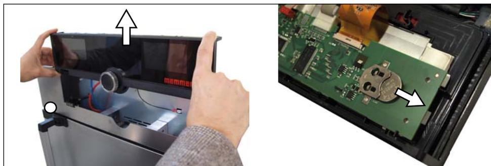
Abb. 25 Lithiumbatterie entfernen
