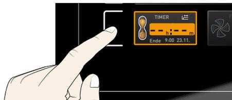
2. Drehknopf drehen, bis die gewünschte Laufzeit – in diesem Beispiel 4 Stunden 30 Minuten – angezeigt wird. Darunter wird in kleinem Format die berechnete voraussichtliche Endzeit angezeigt.
