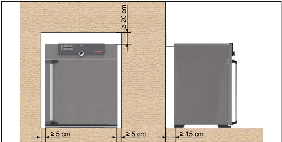
Abb. 8 Mindestabstände zu Wänden und zur Decke
