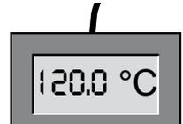
Mit Cal1 kann auf dieselbe Weise eine weitere Abgleichtemperatur unterhalb von Cal2 justiert werden, mit Cal3 eine darüberliegende. Der Mindestabstand zwischen den Cal-Werten beträgt bei Universalschränken UN.../UF... 20 K und bei Brutschränken IN.../IF... 10 K.
