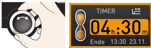
**i** Bis 23 Stunden 59 Minuten wird die Zeit im Format hh:mm (Stunden:Minuten) angezeigt, ab 24 Stunden im Format dd:hh (Tage:Stunden). Die maximale Laufzeit beträgt 99 Tage und 00 Stunden.
