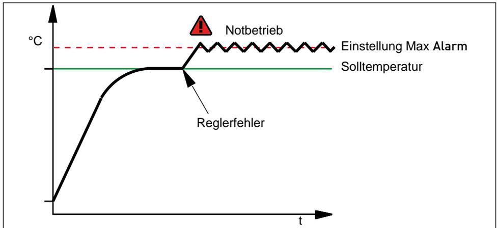
Abb. 17 Schematische Darstellung Funktionsweise elektronische Temperaturüberwachung TWW
