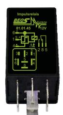
Erfolgt eine zentrale Spannungsabschaltung oder ein Ausfall der Versorgungsspannung, wird das Relais sofort auf 0 (Anfangszustand AUS) zurückgesetzt. Bei Wiederkehr der Versorgungsspannung bleibt aus Sicherheitsüberlegungen der Zustand 0 (nicht eingeschaltet) bestehen, bis ein neuer Startimpuls ausgelöst wird. Die zeitverzögerte Ausschaltung ist werkseitig auf ca. 10 Sek. eingestellt.
