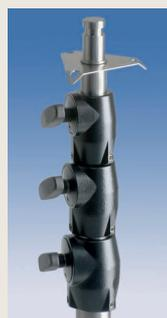
Die dreieckige Abspannplatte für die Befestigung der Karabinerhaken der Abspannseile ist direkt unterhalb des DIN-Zapfens angebracht.
