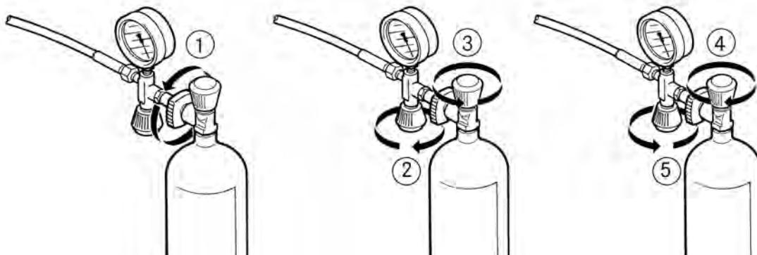
Abb. 19 Druckluftflaschen füllen
