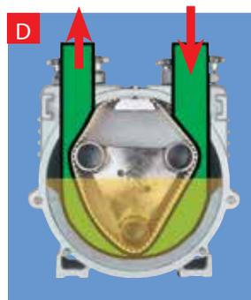
Bei jeder Rotordrehung wird über die Gleitschuhe ständig dem druckseitigen Ausgang Medium zugeführt (verdrängt), während saugseitig die gleiche Fördermenge durch den Unterdruck nachgeführt (angesaugt) wird.
