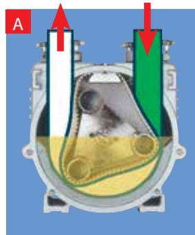
Der Rotor dreht sich innerhalb des fest verschraubten Trennteils im schmiermittelgefüllten Pumpengehäuse. Durch das passgenaue Trennteil wird das Gehäuse in zwei komplett abgeschlossene Funktionsräume getrennt. Beim Zusammendrücken des Förderschlauches kommt es zu einer hermetischen Trennung zwischen Saug- und Druckseite.
