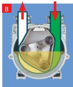
Die Luft aus dem Raum auf der Saugseite wird durch die Rotation des Rotors über das Trennteil durch einen zusätzl. Kanal im Pumpendeckel nach außen verdrängt. Es baut sich innerhalb kurzer Zeit in Abhängigkeit der Saughöhe ein entsprechendes Vakuum auf. Dieses unterstützt zusätzlich die Rückstellkraft des Schlauches zur Wiederherstellung seines ursprünglichen vollen Querschnitts.
