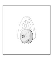
• Überprüfen Sie den Zustand der Laufrolle (Kratzer, Deformierungen, Risse, Korrosionserscheinungen, Fremdkörper usw.).
