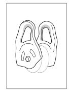
Überprüfen Sie den Zustand der Verbindungsösen (Kratzer, Deformierungen, Risse, Korrosionserscheinungen usw.).
