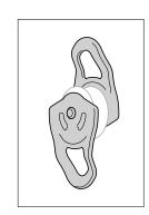
• Überprüfen Sie den Zustand der Seitenteile (Kratzer, Deformierungen, Risse, Korrosionserscheinungen, Abnutzung usw.).
