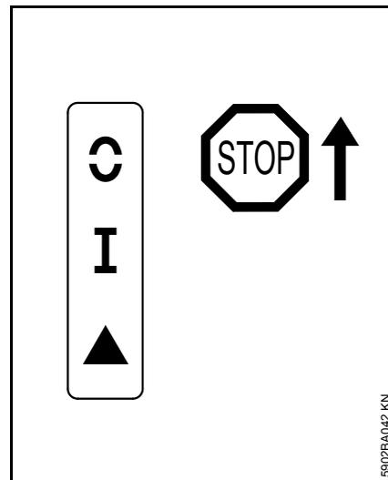
**STOP** bzw. 0 – zum Ausschalten der Zündung muss der Kombihebel in Richtung **STOP** bzw. 0 gedrückt werden. Nach Loslassen federt der Kombihebel in die Betriebsstellung I zurück.
