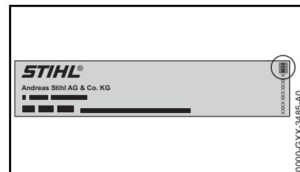
Die Version der STIHL M-Tronic ist auf dem Zulassungsschild der Motorsäge angegeben, z. B. "M3.0" für STIHL M-Tronic Version 3.0.
