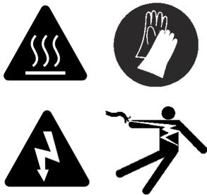
**VERBENNUNGS- UND STROMSCHLAGGEFAHR – ISOLIERHANDSCHUHE TRAGEN**
