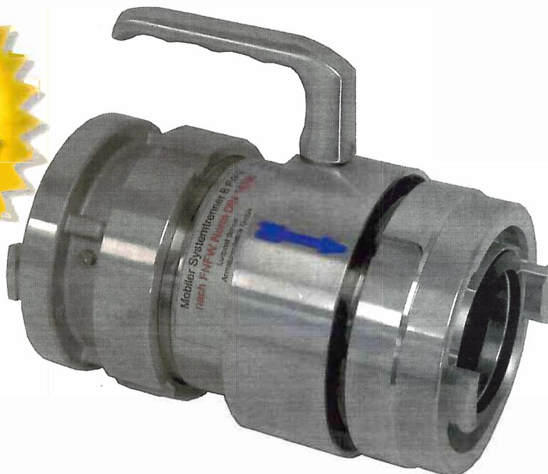
Der Feuerwehr Systemtrenner B-FW Typ „F2“ nach FDFW Norm DIN 14346 mit einem Durchsatz von 1600 l/min bei einem Druckabfall unter 1 Bar
