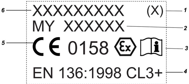
Abb. 8 Kennzeichnung des Maskenkörpers
