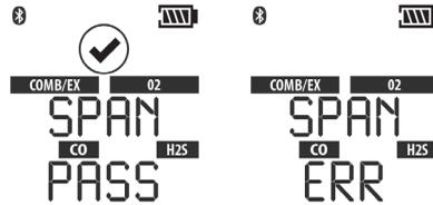
Wenn das Ende der Lebensdauer eines Sensors in Kürze erreicht wird, folgt auf diese "SPAN PASS"-Anzeige die Lebensdauerablaufwarnung für den Sensor (♥-Symbol). Das ♥-Symbol, zusammen mit der Gasart des Sensors, der in Kürze das Ende der Lebensdauer erreicht, blinkt für 15 Sekunden, wenn das Gerät in den Normalbetriebsmodus zurückkehrt. Im Normalbetriebsmodus wird das ♥-Symbol permanent angezeigt.
