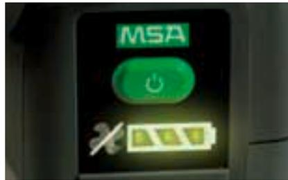
Elektronische Überwachung der Gerätefunktionen für zusätzliche Sicherheit. Optische und akustische 5-stufige Anzeige des Batterie-Ladezustandes. Einfache Ein-Knopf-Bedienung, die zugleich ein unbeabsichtigtes Ausschalten verhindert.
