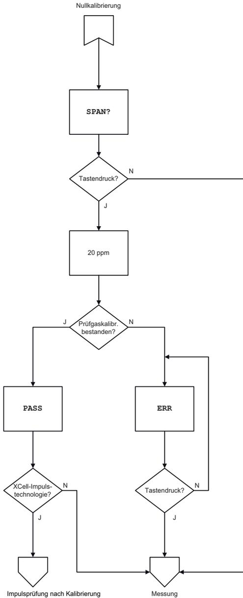
Abb. 12 Prüfgaskalibrierung
