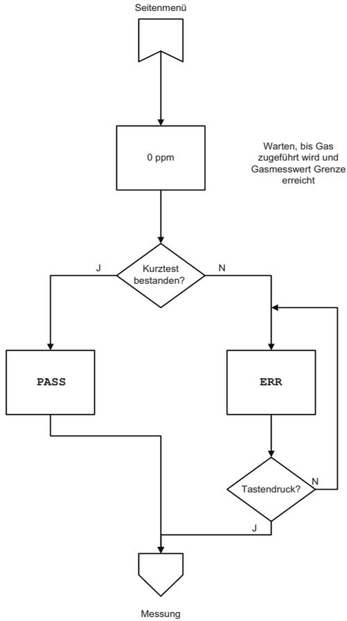
Abb. 9 Kurztest für Geräte ohne XCell-Impulstechnologie
