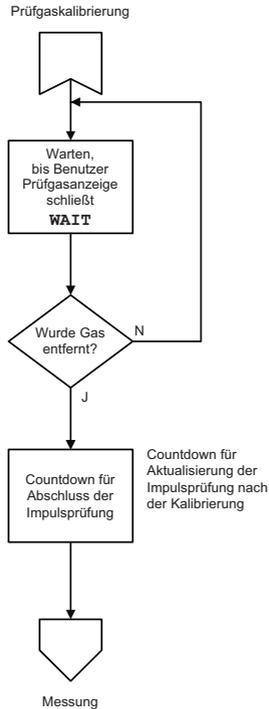
Abb. 13 Impulsprüfung nach Kalibrierung für Geräte mit XCell-Impulstechnologie
