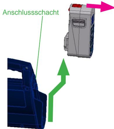
2. Jetzt kann der Akku im Ladegerät wieder aufgeladen werden (beachten Sie hierzu die separate Betriebsanleitung des Ladegerätes und des verwendeten Akkus).
