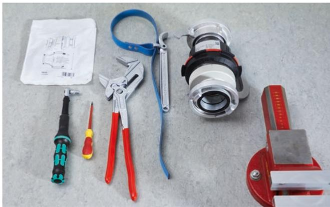
Standardwerkzeug bereithalten und Gerät in Schraubstock einspannen.
