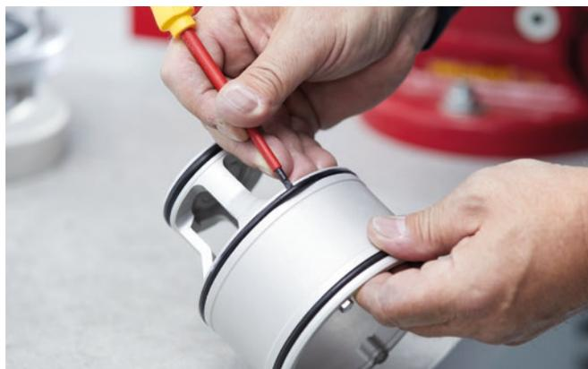
Dichtringe bei Bedarf tauschen. Danach Zusammenbau in umgekehrter Reihenfolge und Systemtrenner prüfen.
