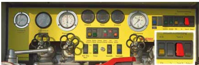
*Pumpenbedienstand mit eingebundener Druckzumisanlage. Das Fahrzeug verfügt über zwei Schaumtanks (Tank 1, Tank 2). Ein Umschalten auf Tank 2 ist mittels Bedienung des Sicherheitsschalters (gesichert mit roter Kappe) möglich.*
