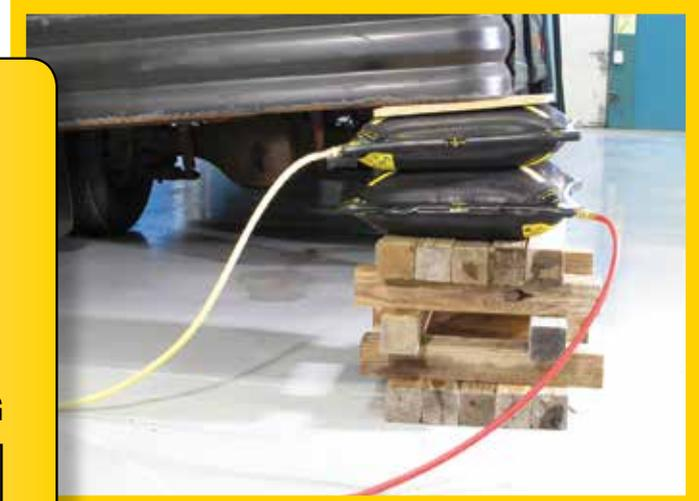
**VOLLSTÄNDIG KOMPATIBEL MIT ALLEN ÄLTEREN MAXIFORCE® HEBEKISSEN UND STEUERGERÄTEN**
