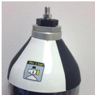
Abb.Y1: Flasche mit kleinem Ventil und Innendruck von 2 bar
