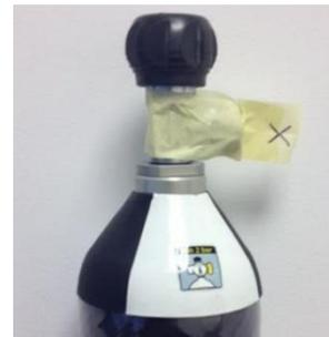
Abb.Y4: Flasche mit offenem Ventil und manipulationssicherem Band
