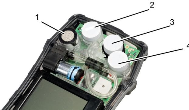
Bild 14 Mögliche Positionen für den Austausch von Sensoren
