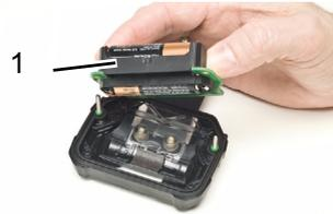
Bild 13 Auswechseln des Akkus
