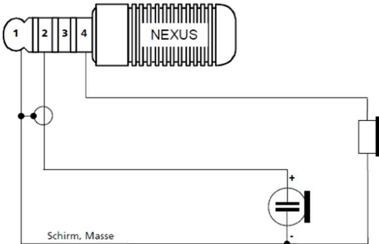
*Mikrofon und Lautsprecher sind mit dem gleichen Masseanschluss verbunden.*
