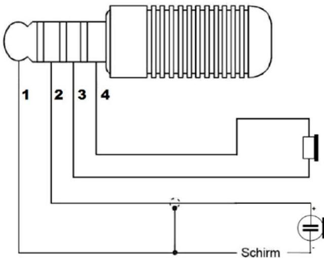
*Das Mikrofon ist mit dem Massekabel verbunden und der Lautsprecher hat einen zusätzlichen negativen Spannungsanschluss.*
