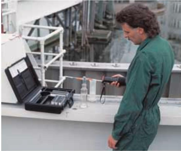
Das Wasseranalyse-Set ermöglicht einen mit geringem Aufwand durchzuführenden Schnelltest, um in Wasserproben Konzentrationen leichtflüchtiger Stoffe [zum Beispiel Perchloräthylen, Benzol...] in mg/l nachweisen zu können.
