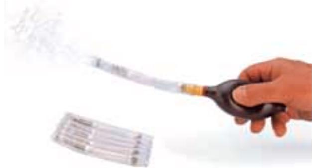
Rauchröhrchen [korrosionsarm] mit Rauch-Handpumpe
