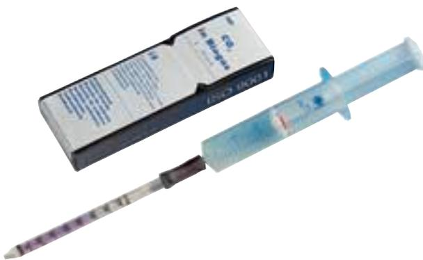
Durch bakteriellen Abbau von organischen Materialien in Biogas-Reaktoren entsteht ein Gas, das zu ca. <sup>2</sup>/<sub>3</sub> Methan [CH<sub>4</sub>] und zu <sup>1</sup>/<sub>3</sub> Kohlenstoffdioxid [CO<sub>2</sub>] enthält. Über die Bestimmung des Kohlenstoffdioxidgehaltes lässt sich der bakterielle Abbau und damit die Biogas-Erzeugung kontrollieren.
