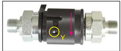
Vor dem Kuppeln Staubschutzkappen abnehmen, dann Verriegelungshülse der Muffe (Position X) zurückziehen und halten. Nippel und Muffe zusammenstecken und die Verriegelungshülse loslassen. Abschließend die Verriegelungshülse in Position Y drehen. Die Verbindung ist nun hergestellt und gesichert. Das Entkoppeln erfolgt in umgekehrter Reihenfolge.
