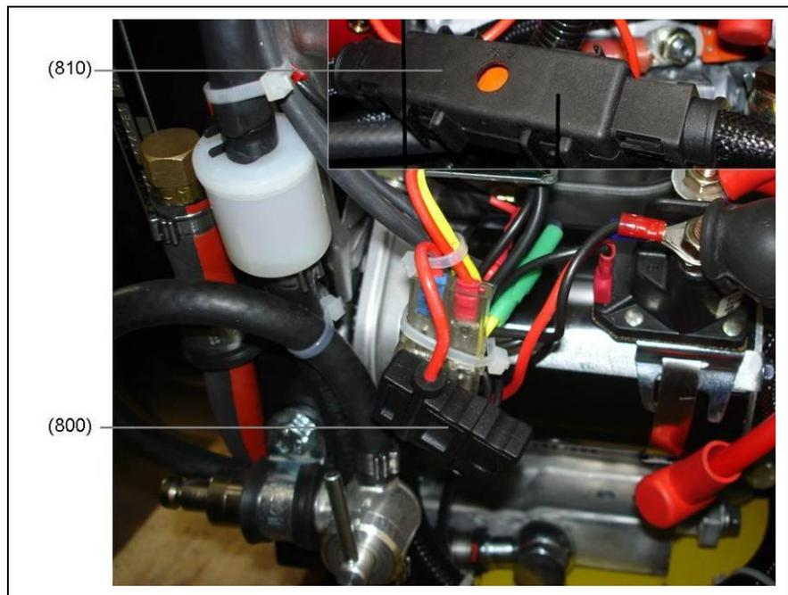
Abb. 9-4: Ersatzteile Sicherungen
