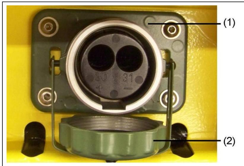
Abb. 5-6: Fremdstartereinrichtung anschließen
