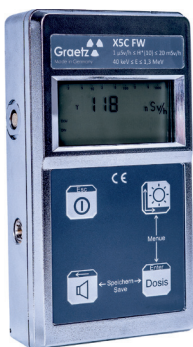
Dosisleistungsmessgerät X5C FW Messbereich: 0 - 20 mSv/h Warnschwelle: 25 µSv/h
