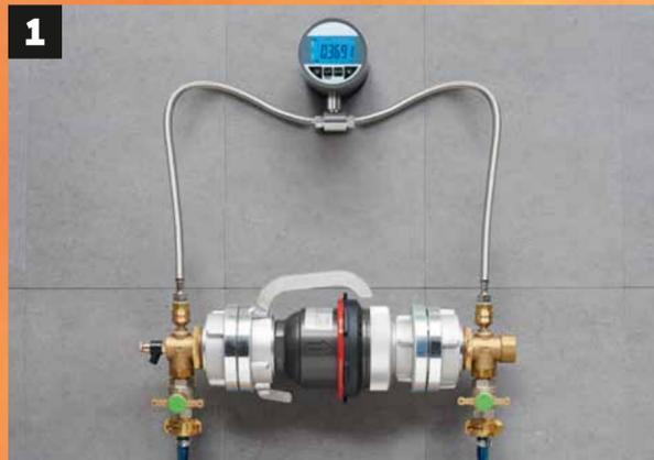
**1** TKA112 an den BFW112 anschließen, Entleerungsventil eingangsseitig. Schläuche zur Wasserversorgung und zum Abfluss (optional) anschließen.
