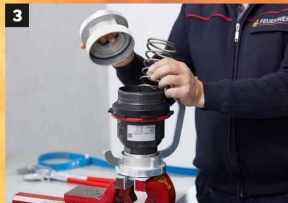
**3** Spannungsfreie Feder entfernen.
