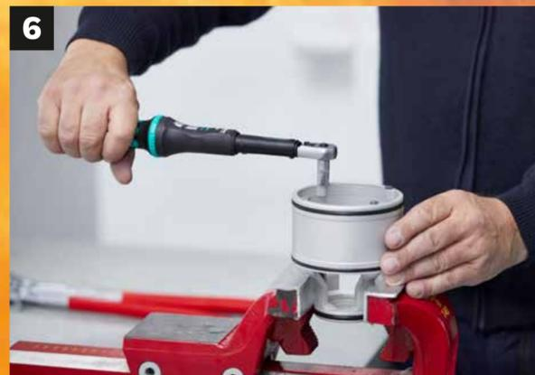
**6** Kolben vorsichtig in Schraubstock einspannen und 4 Schrauben lösen.
