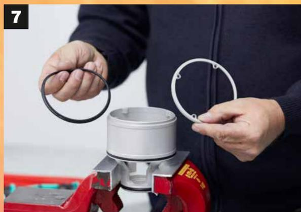
**7** Formdichtung entfernen, neue einlegen und 4 Schrauben über Kreuz anziehen (Drehmoment 4 Nm).
