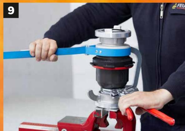
**9** Deckel verschrauben und Systemtrenner mit TKA112 Prüfset testen (siehe Prüfung).
