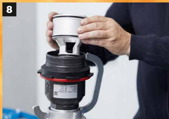
**8** Kolben und Feder wieder einsetzen.
