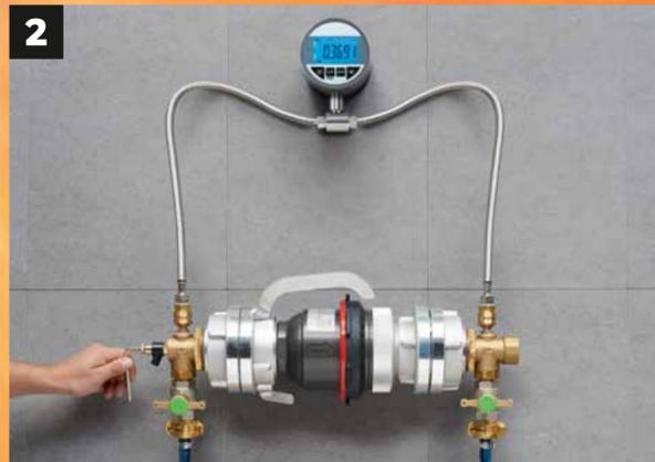
**2** Entleerungsventil schließen, Kugelhähne öffnen. System entlüften. Kugelhähne schließen und über Entleerungsventil Druck langsam ablassen.
