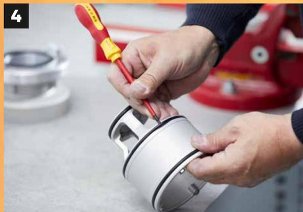
**4** O-Ringe prüfen und ggf. mittels Schraubendreher entfernen.
