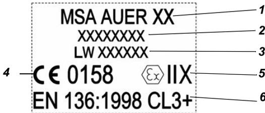
Abb. 2 Kennzeichnung des Maskenkörpers
