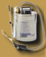
**BioVersal BSG 18 VA** Edelstahl-Tragsprühergerät 18 L., optimiert für die umweltgerechte Ölspurenbeseitigung mit BioVersal FW. Sprühfläche bis ca. 40 m<sup>2</sup> oder ca. 200 lfm Ölspur. Sprühvolumen 18 L., Leergewicht 5 Kg, Betriebsdruck 6 bar. Handpumpeinrichtung. Tragweise: Rücken
