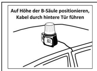
Die Positionierung erfolgt über der B-Säule, Lautsprecher in Fahrtrichtung (nicht zu weit außen befestigen und auf Rillen etc. achten). Das Blaulicht muss horizontal und ungehindert gleichmäßig in alle Richtungen abstrahlen können. Darauf achten, dass die Magnete vollflächig aufliegen.
