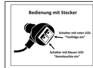
Das Kabel locker zum Zigarettenanzünder vorlegen und gegen versehentliches Abziehen sichern! Das Kabel darf den Fahrer nicht behindern!
