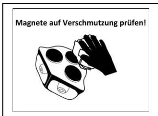
Magnete der WinSig M reinigen. Darauf achten, dass sich während der Lagerung keine Metallteile auf den Magneten angesammelt haben, die eventuell das Dach verkratzen können.
