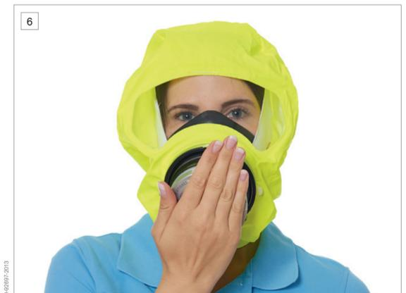
6 Prüfen Sie den Dichtsitz, indem Sie die Filteröffnung mit dem Handballen verschließen und einatmen. Ist ein Luftzug spürbar, korrigieren Sie den Sitz der Halbmaske.
