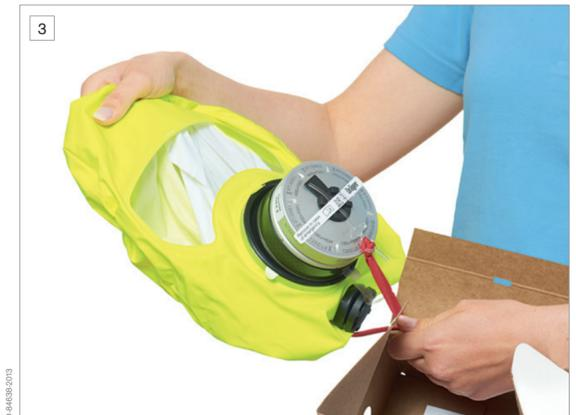
3 Halten Sie die roten Aufreißbänder mit der einen Hand fest und ziehen Sie mit der anderen Hand solange an der Fluchhaube, bis beide Filterstopfen vom Filter entfernt sind.
