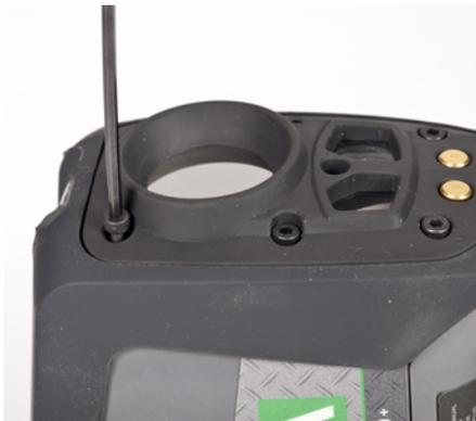
Bild 17 Germaniumlinsenaufnahme, zu entfernende Schrauben
