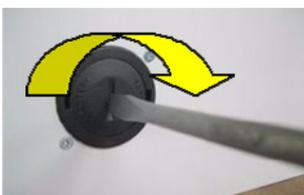
(6) Den Batteriefachdeckel durch Drehung mit einem Schraubendreher oder einer Münze nach rechts schließen.
