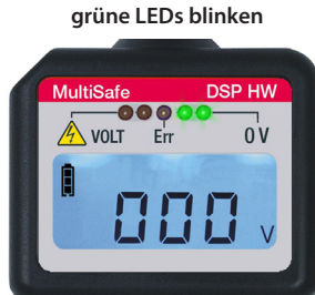
keine Spannung vorhanden Wasser hat Erdpotential
