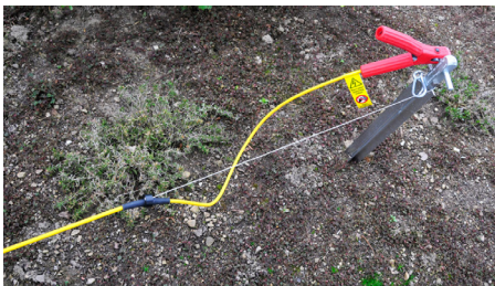
Erdung mit einem Erdungspieß
