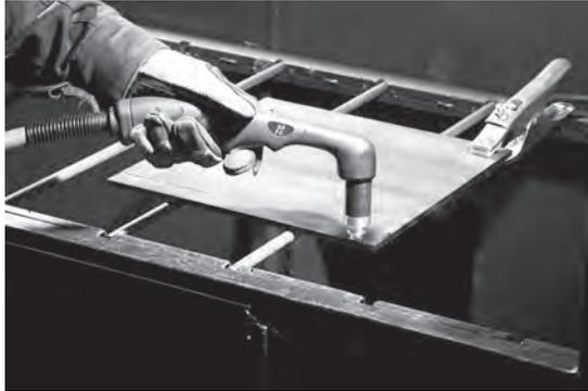
2. Betätigen Sie den Wippentaster des Brenners, um den Lichtbogen zu starten. Halten Sie den Brenner an der Kante kurz an, bis der Lichtbogen das Werkstück vollständig durchgeschnitten hat.
