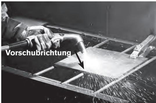
3. Behalten Sie beim Eindringen in die Fuge einen Winkel von ca. 45° zum Werkstück bei. Schieben Sie den Plasmabogen in Richtung der zu erzeugenden Fuge. Damit sich die Standzeit des Verschleißteils nicht verkürzt oder der Brenner beschädigt wird, halten Sie die Brennerdüse in etwas Abstand zum geschmolzenen Metall.
