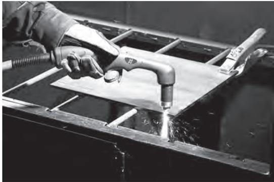
3. Ziehen Sie die Düse leicht über das Werkstück, um mit dem Schneiden fortzufahren. Halten Sie ein stetiges, gleichmäßiges Tempo aufrecht.
