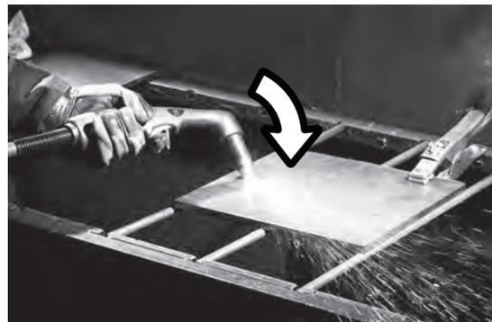
3. Halten Sie den Brenner an Ort und Stelle, während Sie den Wippentaster weiterhin betätigen. Wenn unter dem Werkstück Funken erzeugt werden, hat der Lichtbogen das Material durchstoßen.
