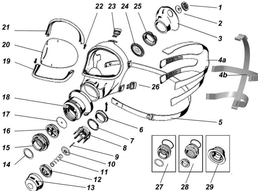
Abb. 4 Vollmaske, Explosionsdarstellung
