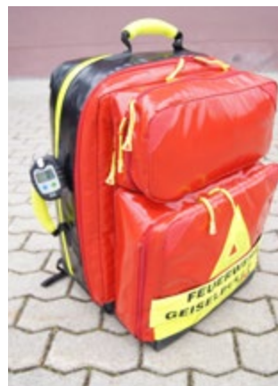
Abb. 1 empfohlene Trageweisen von CO-Warngeräten
