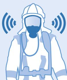
Zur Funktionsprüfung wird in die Maske gesprochen. Nach Einschalten der Kommunikationseinheit muss die Sprache deutlich hörbar nach außen verstärkt sein.
