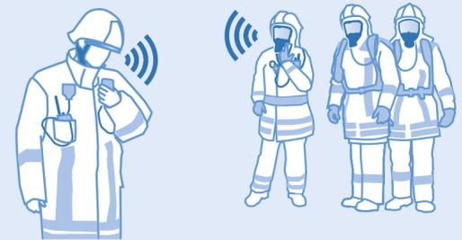
Das Funkgerät einschalten und für die Funktionsprüfung den Push-to-Talk-Knopf drücken.
