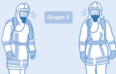
Der Verbindungsaufbau innerhalb der Gruppe erfolgt innerhalb weniger Millisekunden automatisch nach dem Einschalten. Zur Funktionsprüfung sprechen nacheinander alle Truppmitglieder und prüfen die Übertragung.
