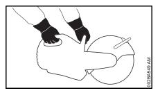
Motorgerät immer mit beiden Händen festhalten: Rechte Hand am hinteren Handgriff – auch bei Linkshändern. Zur sicheren Führung Griffrohr und Handgriff mit den Daumen fest umfassen.
