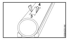
wenn nach erfolgten Schnitten das abgetrennte Teil in der Aussparung verbleibt (wegen verwendeter Keile, Stege), keine weiteren Schnitte durchführen – abgetrenntes Teil brechen
