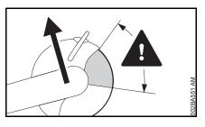
Bei einem Rückschlag (Kickback) wird der Trennschleifer plötzlich und unkontrollierbar zum Benutzer geschleudert.
