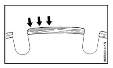
Aufbauschneiden bilden sich als hellgrauer Belag an den Oberseiten der Diamantsegmente. Dieser Belag setzt die Diamanten in den Segmenten zu und stumpft die Segmente ab.
