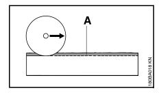
Führungsnut (A) entlang der angezeichneten Linie einschleifen
