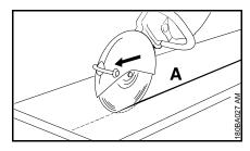
Entlang der Trennlinie arbeiten. Bei Korrekturen die Trennschleifscheibe nicht verkanten, sondern stets neu ansetzen – die Schnitttiefe pro Arbeitsgang soll höchstens 5 bis 6 cm betragen. Dickeres Material in mehreren Arbeitsgängen trennen
