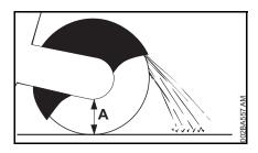
Die Vorgehensweise ist abhängig vom Außendurchmesser des Rohres und der maximal möglichen Schnitttiefe der Trennschleifscheibe (A).
