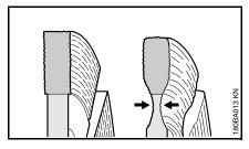
Beim Trennen von Fahrbahndecken nicht in die Tragschicht (häufig Schotter) eindringen – Trennschleifen im Schotter ist am hellen Staub zu erkennen – dabei kann übermäßiger Kernverschleiß auftreten – **Bruchgefahr!**
