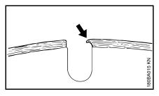
Wird mit stumpfen Segmenten weitergearbeitet, können diese wegen der hohen Hitzeentwicklung weich werden – das Stammblatt glüht aus und verliert seine Festigkeit – dies kann zu Verspannungen führen, deutlich erkennbar an Taumelbewegungen der Trennschleifscheibe. Die Trennschleifscheibe nicht weiter verwenden – **Unfallgefahr!**
