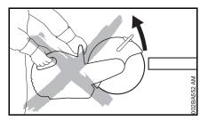
möglichst nicht mit dem oberen Viertel der Trennschleifscheibe schneiden. Trennschleifscheibe nur mit äußerster Vorsicht in einen Schnitt einbringen, nicht verdrehen oder in den Schnitt hineinstoßen
