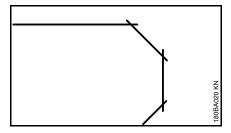
Kurven in mehreren Arbeitsgängen herstellen – darauf achten, dass die Trennschleifscheibe nicht verkantet
