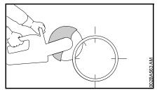
zweiter seitlicher Schnitt im markierten Bereich – keinesfalls in den Bereich des letzten Schnitts schneiden, um sicheren Halt des abzutrennenden Rohrteils zu gewährleisten
