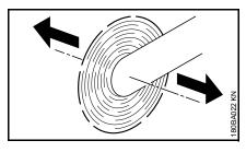
Wird ein Trennschleifer mit einer rotierenden Trennschleifscheibe in Pfeilrichtung bewegt, entsteht eine Kraft, die das Gerät zu kippen versucht.
