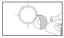
gegenüberliegende untere Seite mit dem oberen Viertel der Trennschleifscheibe schneiden
