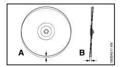
Eine zu große Rundlaufabweichung (A) überlastet einzelne Diamantsegmente, die sich dabei erhitzen. Dies kann zu Spannungsrissen im Stammblatt oder zum Ausglühen einzelner Segmente führen.
