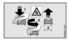
Niemals den Bajonett-Tankverschluss mit einem Werkzeug öffnen oder schließen. Der Verschluss kann dabei beschädigt werden und Kraftstoff ausfließen.
