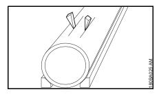
Keile verwenden und/oder Stege stehen lassen, die nach erfolgten Schnitten gebrochen werden
