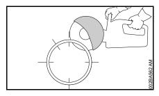
erster seitlicher Schnitt an der oberen Rohrhälfte
