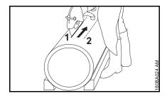
Trennschnitte immer so ausführen, dass die Trennschleifscheibe nicht eingeklemmt wird
