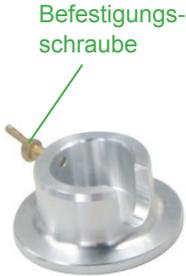
Fußplatten vergrößern die Bodenfläche der Zylinder und erhöhen ihre Standsicherheit. Der Zylinder wird in die Fußplatte gestellt und mit der Flügelschraube befestigt beziehungsweise gesichert.
