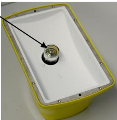
der Raum ist, umso kürzer ist die Erholzeit des Photomultipliers. Nach der Reparatur einer Folie bei "Tageslicht" kann die Erholzeit des Photomultipliers mehrere Stunden betragen.
