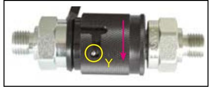
Vor dem Kuppeln Staubschutzkappen abnehmen, dann Verriegelungshülse der Muffe (Position X) zurückziehen und halten. Nippel und Muffe zusammenstecken und die Verriegelungshülse loslassen. Abschließend die Verriegelungshülse in Position Y drehen. Die Verbindung ist nun hergestellt und gesichert. Das Entkuppeln erfolgt in umgekehrter Reihenfolge.
