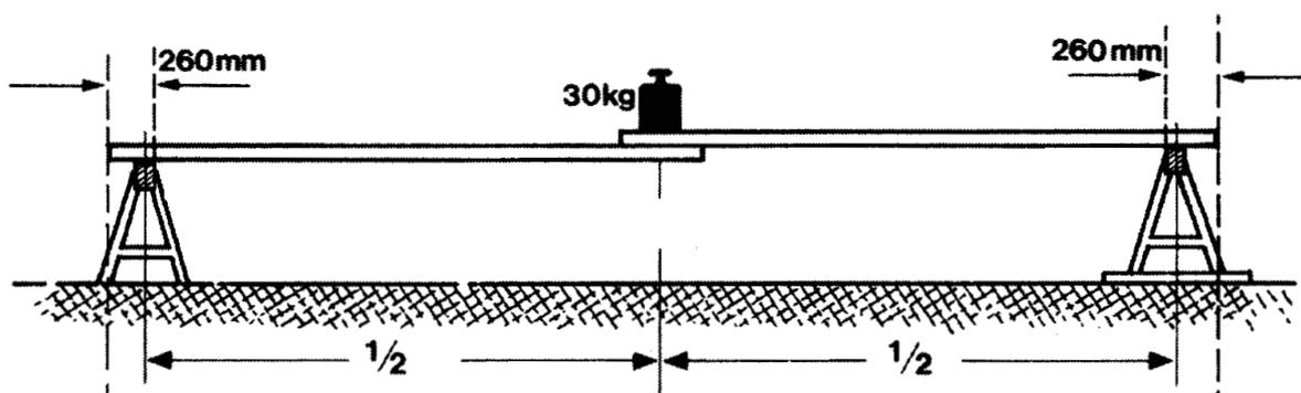
Die Leiter ist betriebssicher, wenn nach der Belastungsprüfung weder Schäden noch bleibende Formänderungen feststellbar sind.
