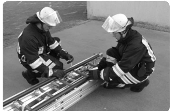
Zwei Personen nehmen die Stützstangen auf und sichern den Leiterfuß. Zwei weitere Personen am Leiterkopf richten die Leiter auf, wobei die beiden Personen an den Stützstangen durch Ziehen das Aufrichten unterstützen.
