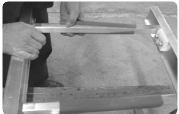
Klemmen Sie den Sprossenbelag und das Halteblech mit Schraubzwingen an der Sprosse fest. Achten Sie darauf, dass der Belag sauber an der Sprosse anliegt.
