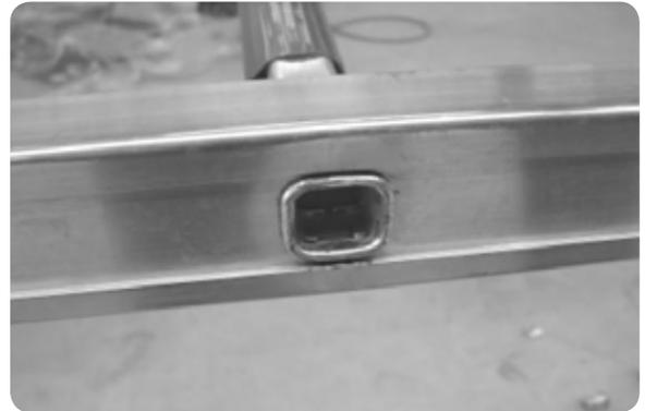
Nachdem Bördel müssen Sie den Sprossenbelag auf die Sprossenmitte ausrichten und mit einer Heißluftpistole auf die Sprosse aufschumpfen.
