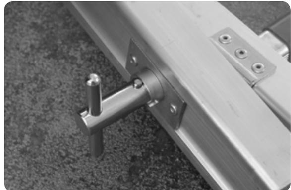
Um die Leiterteile zusammen zu stecken halten zwei Personen die unteren Leiternteile an der oberen Sprosse mit der einen Hand hoch, mit der anderen Hand betätigen sie den Federbolzen der oberen Leiter. Die anderen Personen schieben jetzt die Leiterteile zusammen.
