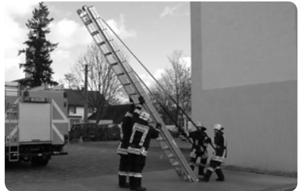
Wenn die Leiter am Boden liegt, werden beide Stützstangen in die Halter gelegt und mit den Halterriemen befestigt. Das Zugseil ist an der Leiter zu sichern.
