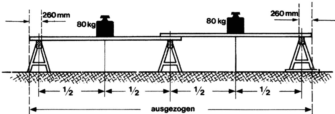
Die Schiebleiter wird an der Überlappung mit 30 kg belastet.
