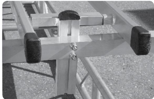
Bringen Sie alle anderen Teile in die exakte Position, um den Test durchzuführen zu können. Erst wenn Sie sichergestellt haben, dass der Prüfaufbau stimmt, befestigen Sie den Auflagebock am Leiterende mit den Befestigungsschellen an den Traversen, so dass ein Lösen des Bocks ausgeschlossen ist. Hängen Sie nun das mitgelieferte lose Stahlseil am Haken ein, führen es über die Umlenkrolle und befestigen Sie die Zugwaage mit dem Karabiner am Seil.
