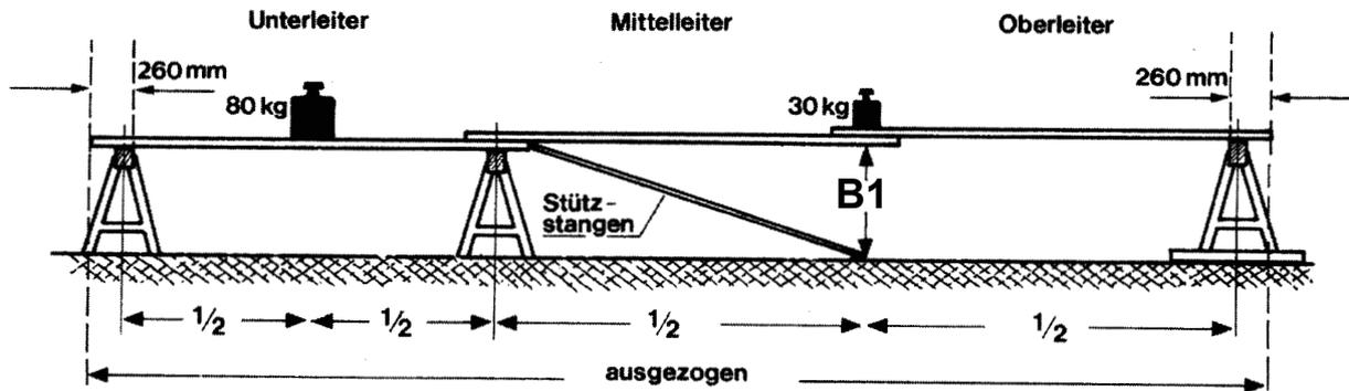
Anschließend wird die andere Überlappungsstelle (siehe Bild 3 und 4) in gleicher Weise geprüft (Messwert A2 und B2)
