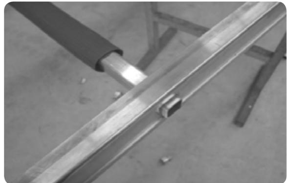
Stellen Sie die Leiter hochkant auf eine Unterlage aus Hartholz. Legen Sie eine Zwischenlage von ca. 2 mm unter die Leiter.
