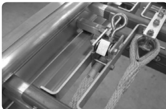
Führen Sie das Auszugsseil unbedingt durch die Ringschraube, da sonst die Bremse nicht gelöst werden kann.
