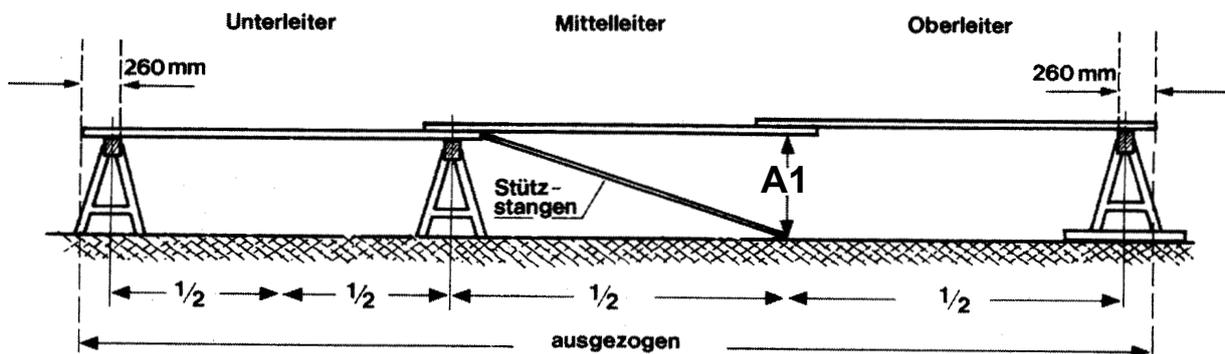
Dort, wo die Leiter nicht unterstützt ist, wird sie mit 30 kg belastet. Das verbleibende Leiterteil wird mit 80 kg belastet. Der Abstand zwischen Boden und Holm an der nicht unterstützten Überlappung (siehe Bild 2) wird gemessen (Messwert B1).
