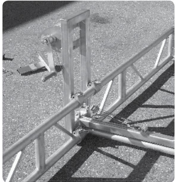
Legen Sie nun das T-Nut-Profil mit der Ringmutter auf die Leiter und hängen Sie die Zugwaage ein.
