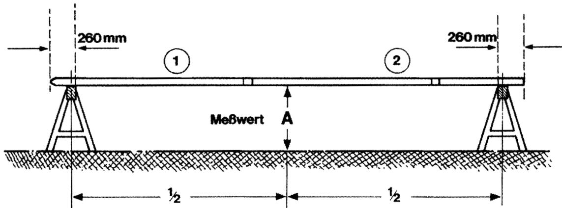
In der Mitte zwischen den beiden Böcken wird nun eine Last von 80 kg auf die Leiterteile aufgebracht. Anschließend wird der Abstand B von einem Punkt in der Mitte der freitragenden Länge bis zu einem lotrecht darunter liegenden Punkt am Boden gemessen (siehe Bild 2).
