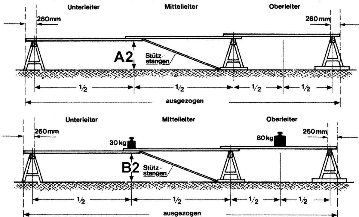
Die Leiter ist betriebssicher, wenn die Durchbiegung unter Last bei der Prüfung der Überlappung von Unter- und Mittel- bzw. von Mittel- und Oberleiter max. 100 mm beträgt und nicht mehr als  $\pm 10$  mm von der vorhergehenden Prüfung abweicht.
