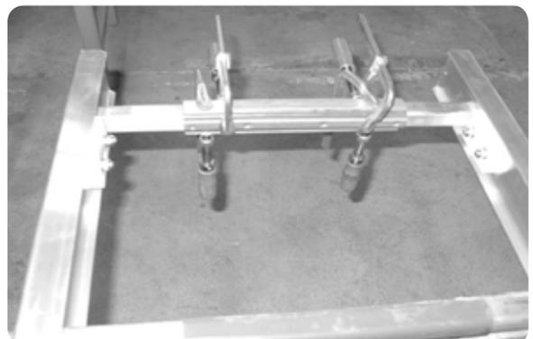
Bohren Sie nun das Lochbild des Halteblechs mit einem Bohrer (Durchmesser 4,5 mm) auf der Sprosse ab.
