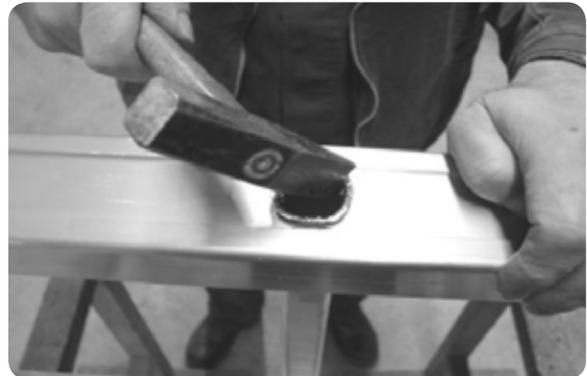
Um eine saubere Bördelung zu erreichen, wird die Verbördelung mit einem Bördeleisen gleichmäßig nachgebördelt.
