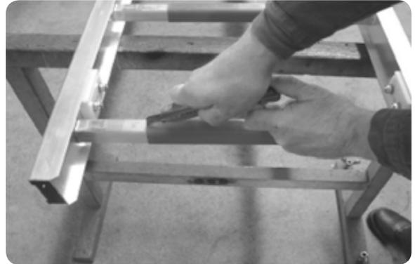
Schieben Sie den neuen Sprossenbelag über die Sprosse. Achten Sie darauf, dass die Öffnung des Sprossenbelags gegen die Laufrichtung zeigt.
