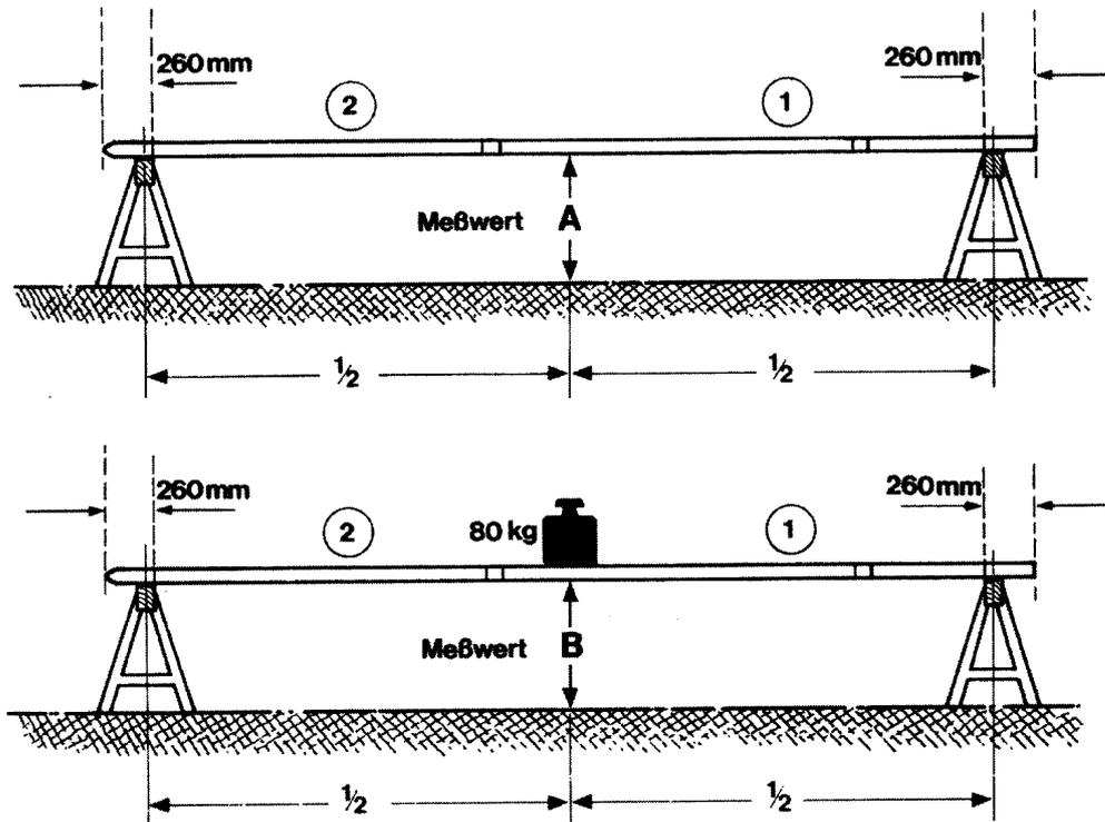
Die Leiter ist betriebssicher, wenn die Differenz zwischen den Messwerten A und B bei Aluminium max. 60 mm bei Holz max. 75 mm beträgt.
